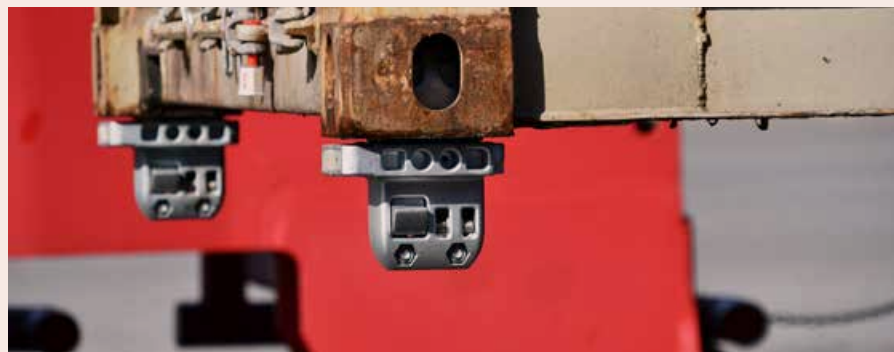
FÖRANKRING. En container som försetts med nya fjärrstyrda låsanordningar från LOX.
